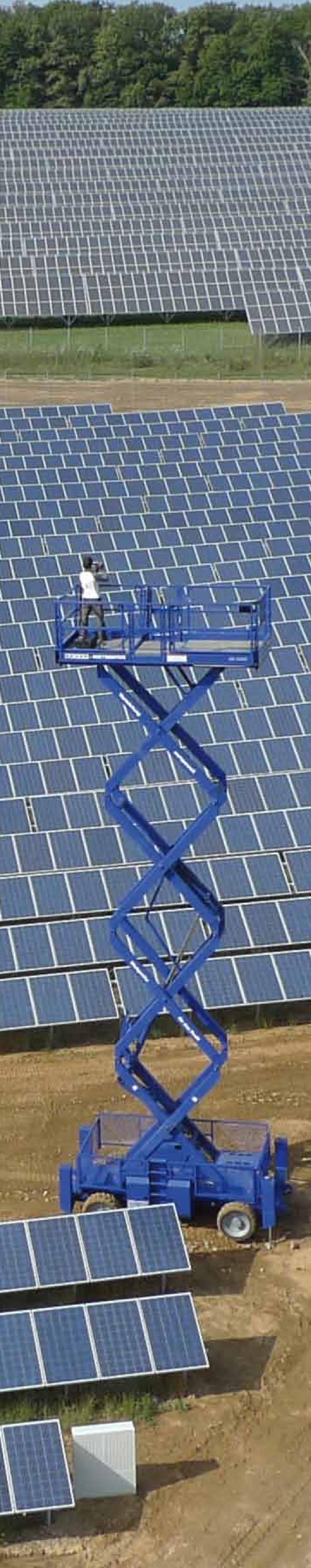
Abb. 3: Vergangenheit trifft Zukunft – bisherige Vermessungsmethode mit einer Hebebühne in einer Multi-MW-PV-Anlage; bei einer Vergleichsmessung mit und von einer fliegenden Kamera-Plattform aus aufgenommen, mit der zukünftige Vermessungen effizienter werden.
